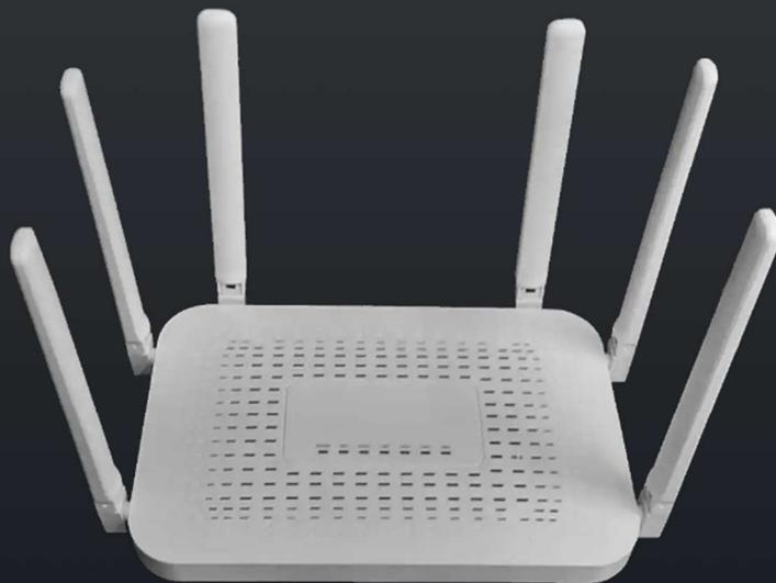
El router **Confiabits mt7981** es un dispositivo de redes que ofrece una conectividad WiFi avanzada. Cuenta con un procesador incorporado de dos núcleos Dual Core ARM 64Bits, que funciona a una frecuencia de 1400 MHz. Además, tiene una memoria interna de 256 MB, lo que permite un rendimiento eficiente.
